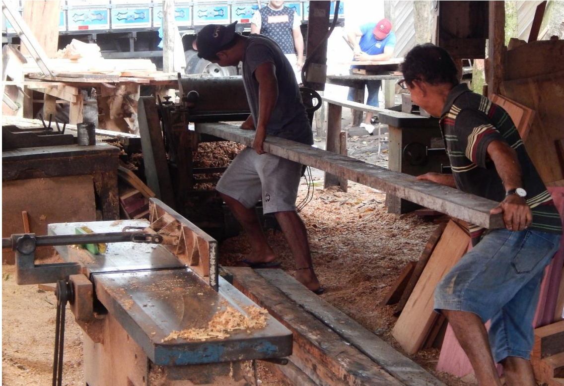
Figura 3 - Raimundo e Timóteo trabalham vigas na plaina desengrossadeira
