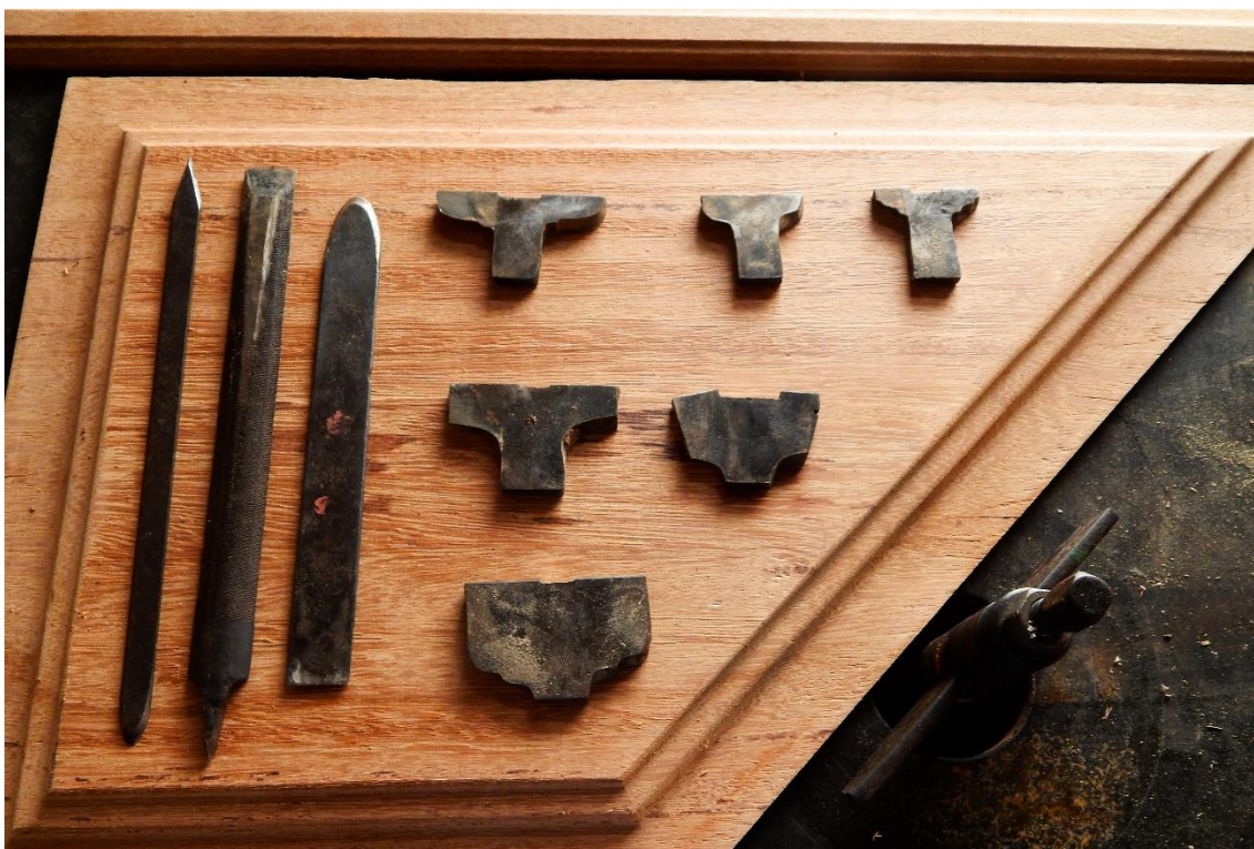
Figura 4 - Fresas feitas por Raimundo sobre peça de madeira que demonstra o resultado da fresa que se encontra montada na máquina
